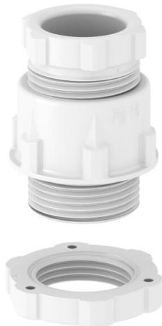
Bucins standard, formato A de acordo com a DIN 46320 com anel de vedação simples NR/SBR, com rosca PG conforme a DIN 40430
