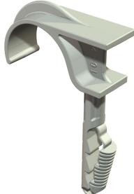
As abraçadeiras de encaixe servem para a colocação de cabos e tubos na parede e teto e a colocação de tubos flexíveis em betão e pavimentos. As abraçadeiras de encaixe simples substituem as abraçadeiras de prego no betão e betão celular. A vantagem das abraçadeiras de encaixe consiste no facto de ser apenas necessário encaixar estas no orifício. Deixa de ser necessário utilizar buchas e parafusos.
