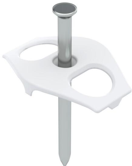
Com prego de aço galvanizado a zinco pré-montado de Ø 3 mm ou 3,5 mm, para a fixação de condutores em paredes e em alvenaria, para 1 ou 2 condutores NYM 3 x 1,5/2,5 mm<sup>2</sup> ou 1 ou 2 condutores NYM 5 x 1,5/2,5 mm<sup>2</sup>.
