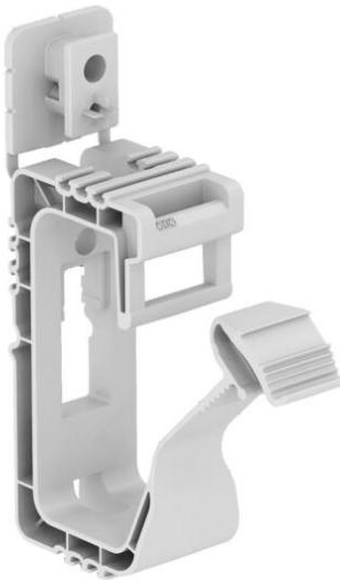
Suporte com elemento de fixação, para instalar até 20 cabos NYM 3 x 1,5 mm<sup>2</sup> na parede ou no teto. Fixação com cavilha de impacto ou cavilha de encaixe. Também adequado para fixação com dispositivos de fixação a gás e a bateria das marcas Bosch, Fischer e Spit (diâmetro interno de Ø 7 mm). Furo de fixação Ø 6 mm. Distância de fixação recomendada com ocupação total de 250-400 mm, dependendo das normas/vários requisitos nacionais aplicáveis.
