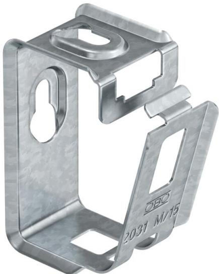
Abraçadeira em metal para uma elevada resistência mecânica, mesmo em caso de incêndio. Adequada para uma montagem segura, sobre tetos corta-fogo. Aprovado também como variante de suporte específico de cabos para manutenção de funções elétricas segundo DIN 4102 parte 12. Para montagem na parede e no teto. A abraçadeira pode ser aberta sem usar ferramentas. Na documentação apropriada de teste, encontram-se informações detalhadas sobre as variantes de instalação aprovadas.
