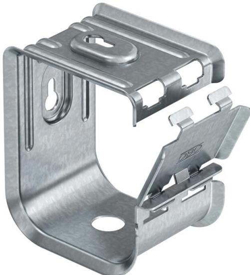
Abraçadeira em metal para uma elevada resistência mecânica, mesmo em caso de incêndio. Adequada para uma montagem segura, sobre tetos corta-fogo. Aprovada também como variante de suporte específico de cabos para manutenção de funções segundo DIN 4102 parte 12. Para montagem na parede e no teto. A abraçadeira pode ser aberta sem usar ferramentas.
