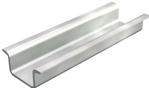
Calha DIN 35 x 15 mm à semelhança de DIN EN 60715 (anteriormente DIN EN 50022), mas com a espessura de material 1,5 mm.
