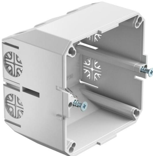
Caixa de aparelhagem para montagem de aparelhos com espelhos em calhas de instalação WDK com altura da calha de 60 mm. A caixa de aparelhagem é encaixada nas paredes da calha e fixada com um parafuso no centro.
