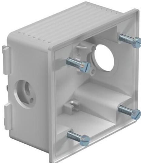
Caixa de aparelhagem para montagem de tomadas CEE em calhas WDK com larguras de calhas a partir de 150 mm. A caixa de aparelhagem pode igualmente ser utilizada como caixa de montagem e de encastramento para aparelhos CEE. Versão plana, 16 e 32 A, com distância entre furos de 60 x 60 mm. O volume de fornecimento inclui 1 abraçadeira com entalhe 1 bucin cónico ED 16, 1 bucin VS 16, assim como 4 parafusos cilíndricos M5 x 18 para a fixação da tomada.
