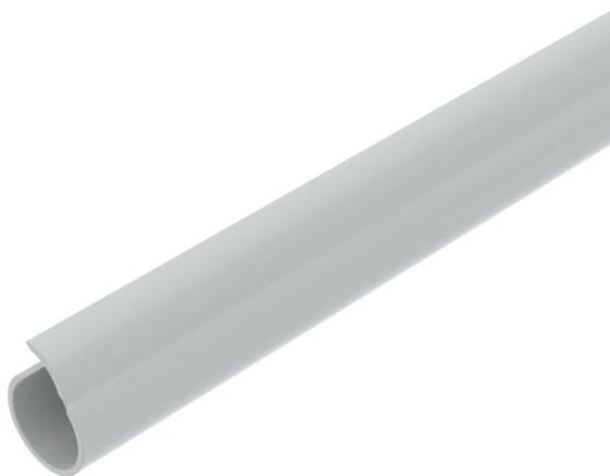
Tubo aberto Quick-Pipe® de plástico para instalação à superfície de cabos e tubos em áreas interiores e áreas exteriores protegidas. Montagem em parede e teto com abraçadeira OBO-Quick, abraçadeira proQuick e abraçadeira Multi-Quick. Fecho e abertura sem ferramentas, girando na abraçadeira. Utilizável com uma amplitude de temperaturas de - 25° a + 60 °C.
