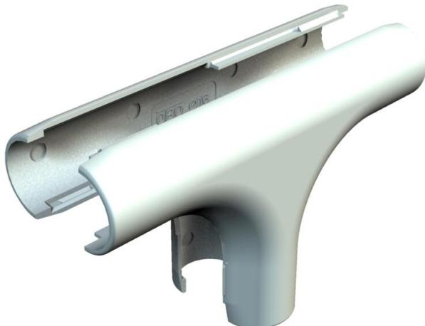
Peça moldada para tubos de instalação elétrica em plástico para a criação de derivação T. Adequada para tubo Quick-Pipe ou tubos corrugados. Fecho e abertura sem ferramentas. Aplicável na amplitude de temperaturas de - 25° a + 60 °C.
