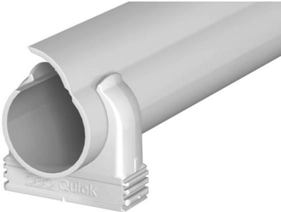
Conjunto de tubos de instalação elétrica Quick-Pipe® e abraçadeiras OBO-Quick para instalação à superfície. Para instalação à superfície de cabos e tubos em áreas interiores e áreas exteriores protegidas. Montagem universal em parede e teto. Inclui 40 m de tubo, com 2 metros de comprimento unitário, e 120 abraçadeiras OBO-Quick. Utilizável com uma amplitude de temperaturas de -25° a + 60 °C.
