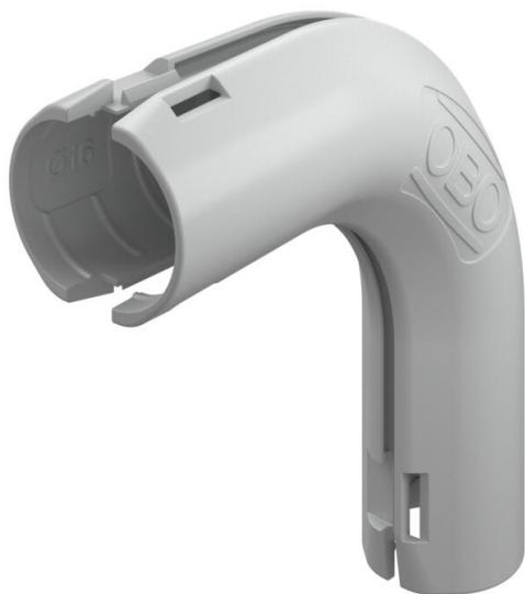
Acessório para tubos de instalação elétrica em plástico para a criação de ângulos de 90°. Adequado para tubo Quick-Pipe® ou tubos corrugados. Fecho e abertura sem ferramentas. Utilizável com uma amplitude de temperaturas de -25° a + 60 °C.
