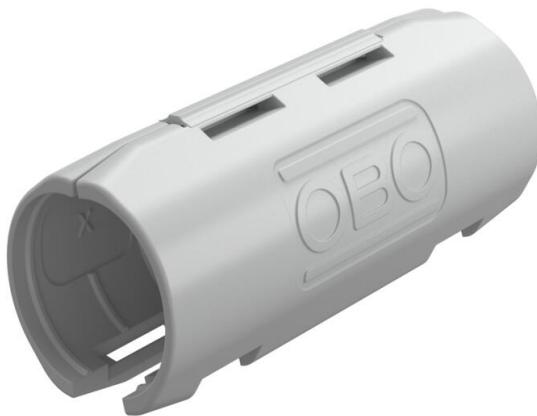
União para tubos de instalação elétrica em plástico para a criação de ligações longitudinais. Adequada para tubo Quick-Pipe® ou tubos corrugados. Fecho e abertura sem ferramentas. Utilizável com uma amplitude de temperaturas de - 25° a + 60 °C.
