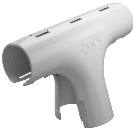
Acessório para tubos de instalação elétrica em plástico para a criação de derivação em T. Adequada para tubo Quick-Pipe® ou tubos corrugados. Fecho e abertura sem ferramentas. Utilizável com uma amplitude de temperaturas de - 25° a + 60 °C.
