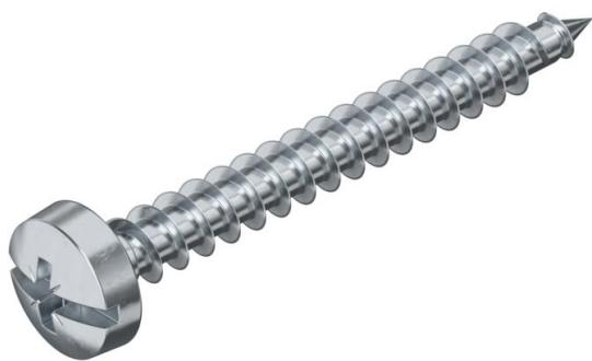
Aço temperado, galvanizado a zinco e passivado a amarelo, bem como revestido a Hostaflon. Panhead com ranhura combinada em cruz e em fenda (Pozidrive tamanho 2 exceto Ø 6 mm Pozidrive tamanho 3).
