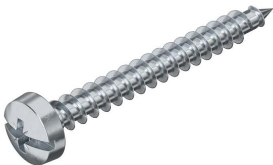
Aço temperado, galvanizado a zinco e revestido a Hostaflon. Panhead com ranhura combinada em cruz e em fenda (Pozidrive tamanho 2 exceto Ø 6 mm Pozidrive tamanho 3).
