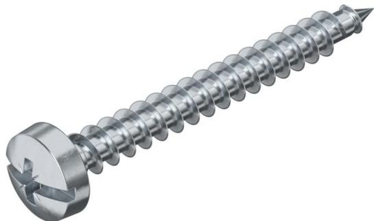
Aço temperado, galvanizado a zinco e revestido a Hostaflon. Panhead com ranhura combinada em cruz e em fenda (Pozi-drive tamanho 2 exceto Ø 6 mm Pozi-drive tamanho 3).
