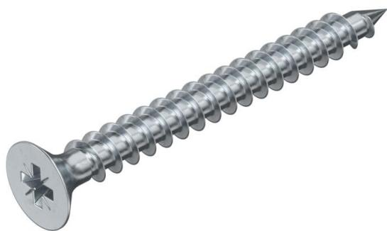
Aço temperado, galvanizado a zinco e revestido a Hostaflon. Cabeça de embeber com parafuso Philips (Pozidrive tamanho 2, exceto Ø 6 mm Pozidrive tamanho 3).
