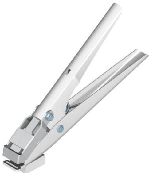
Ferramenta de tensionamento para todas as bandas de fixação OBO, em conjunto com os fechos da banda de fixação apropriados. Pinça de fixação simples, sem função de catraca e dispositivo de corte. Com pegas ergonómicas.
