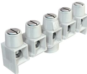
Régua de bornes em latão niquelado, parafusos em aço galvanizados a zinco e passivados de forma transparente, secção transversal nominal 0,8 ÷ 2,5 mm<sup>2</sup>, tensão nominal 660 V, de 5 polos, com conjunto de bornes, máx. secções transversais conectáveis por ponto de borne: 4 x 2,5 mm<sup>2</sup>, 5 x 1,5 mm<sup>2</sup> ou 6 x 1 mm<sup>2</sup>, os polos desnecessários podem ser retirados e utilizados como bornes individuais.
