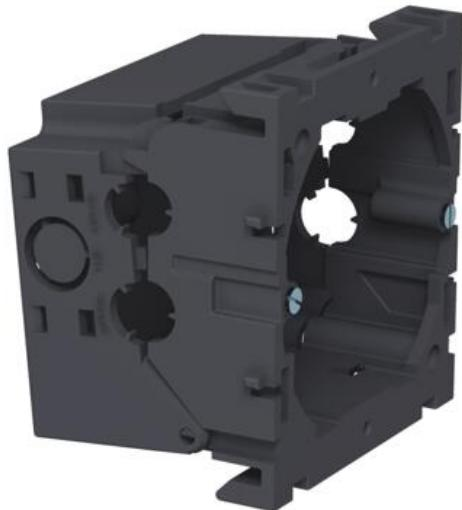
Caixa de aparelhagem com bloqueio frontal para interruptores, com parte inferior articulada e, se necessário, amovível para a ligação de cabo, com entradas para cabos com diâmetro de até 14 mm. Versão livre de halogéneos. Via de fixação horizontal 60 mm.
