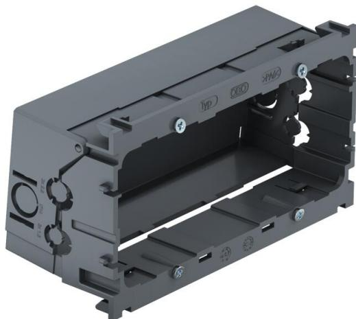
Caixa de aparelhagem com bloqueio frontal para séries de aparelhagem standard, montagem de 2 aparelhos de instalação individuais ou tomada múltipla. Com parte inferior articulada e, se necessário, amovível para a ligação de cabo para poupar tempo, assim como com aberturas de admissão para cabos com diâmetro de até 14 mm. Versão livre de halogéneos. Via de fixação vertical 60 mm.
