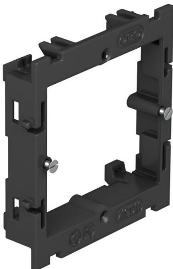
Suporte de montagem para instalação de aparelhagens de conexão de dados em calhas técnicas da série Rapid 80 e colunas de distribuição ISS com abertura de 76,5 mm.
