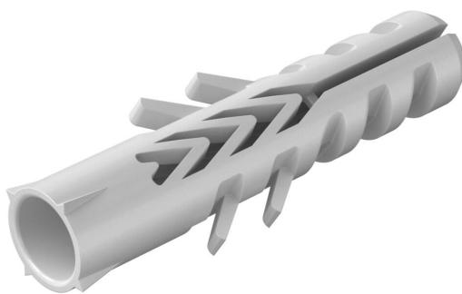
Comprimento mínimo do parafuso necessário = comprimento da bucha + espessura do componente + 1 x Ø do parafuso.
