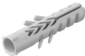
Comprimento mínimo do parafuso necessário = comprimento da bucha + espessura do componente + 1 x Ø do parafuso.
