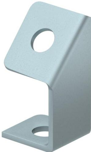
O suporte inclinado é o elemento de ligação para a instalação oblíqua do varão roscado na montagem de parede com caminhos de cabos e escadas de cabos normalizados em manutenção de funções, conforme DIN 4102 parte 12.
