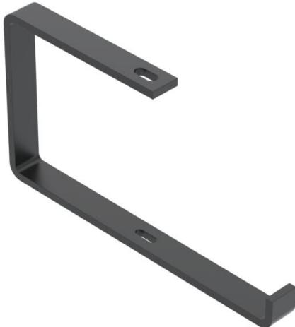
Travessa de pendural para sistemas de suporte de cabos para a fixação directa debaixo do tecto ou como pendural com varão roscado M10. Revestimento preto.
