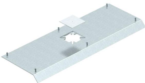
Tampa de ligação do aparelho para a base da calha AIK/U para a montagem de uma Telitank. A tampa da calha é aparafusada nos perfis laterais de alumínio da parte inferior da calha. A aba da tampa fica saliente na parte inferior da calha, num ângulo de 45°.
