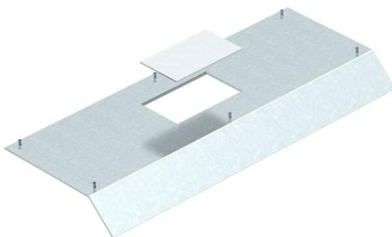
Tampa do adaptador para aparelhos para base da calha AIK/U para a montagem de um adaptador para aparelhos do tamanho 2. Abertura de montagem fechada com espelho cego de alumínio de 2 mm. A tampa da calha é aparafusada nos perfis laterais AI da base da calha. A inclinação da tampa fica saliente na base da calha num ângulo de 45°.
