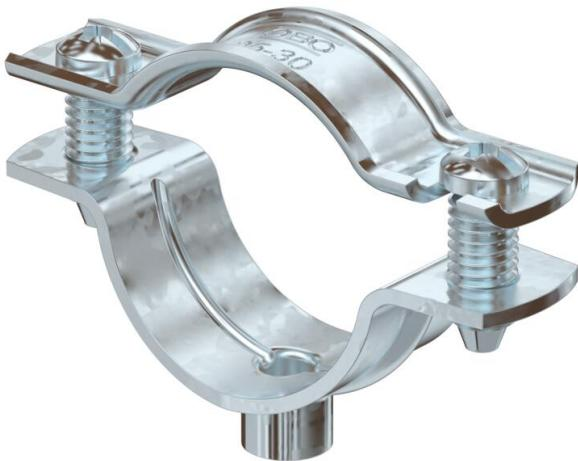
Abraçadeira distanciadora para montagem de tubos e cabos na parede, teto e chão. Com tampa de travamento automático. Fixação através de aplicação com rosca fêmea. Superfícies G e FT, a partir do tamanho 20 da abraçadeira, adequadadas para montagem com pistola de pregos ou pistola para pinos.
