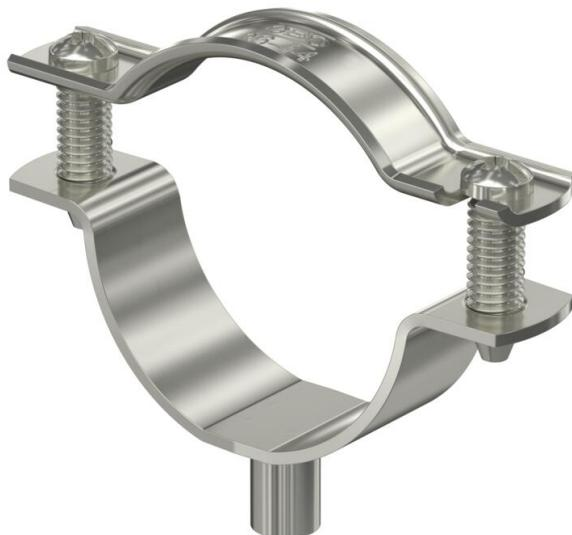
Abraçadeira distanciadora para montagem de tubos e cabos na parede, teto e chão. Com tampa de travamento automático. Fixação através de aplicação com rosca fêmea. Superfícies G e FT, a partir do tamanho 20 da abraçadeira, adequadadas para montagem com pistola de pregos ou pistola para pinos.
