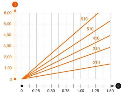
Diagrama de cargas da consola AWG 15
