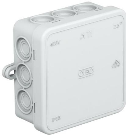
Tipo de proteção IP55, tensão nominal 690 V, secção transversal nominal 2,5 mm<sup>2</sup>, 12 entradas para cabos com diâmetro de 5-14 mm.
