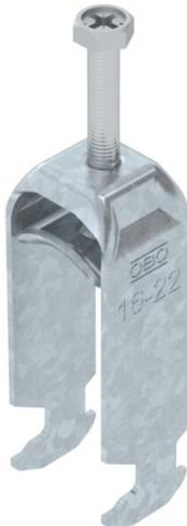
Abraçadeira BBS tipo cabeça de martelo, placa de pressão metálica com arestas arredondadas para proteção de cabos. Para montagem vertical e horizontal de 2 cabos individuais em perfil C. Para largura de rasgo 16 - 17 mm. Com parafuso simples na placa de pressão, cabeça de parafuso hexagonal universal tam. 10, com fenda e fenda em cruz. Adequado para montagem em áreas interiores e exteriores.. Vários cabos devem ser separados por placas duplas. Recomenda-se o uso de uma contraplaca.
