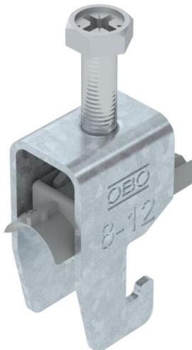
Abraçadeira BBS tipo U, placa de pressão em plástico de polipropileno. Para montagem vertical e horizontal de 1 cabo individual em perfil C. Para largura de rasgo 18 - 22 mm. Com parafuso simples na placa de pressão, cabeça de parafuso hexagonal universal tam. 10, com fenda e fenda em cruz. Adequado para montagem em áreas interiores e exteriores. Recomenda-se o uso de uma contraplaca.
