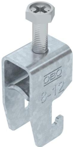
Abraçadeira BBS tipo U, placa de pressão metálica com arestas arredondadas para proteção de cabos. Para montagem vertical e horizontal de 1 cabo individual em perfil C. Para largura de rasgo 18 - 22 mm. Com parafuso simples na placa de pressão, cabeça de parafuso hexagonal universal tam. 10, com fenda e fenda em cruz. Adequado para montagem em áreas interiores e exteriores. Recomenda-se o uso de uma contraplaca.
