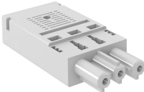
Tomada de 3 polos, tipo GST18i com ligação de parafuso para cabo rígido de 1,5 - 2,5 mm<sup>2</sup> ou multifilar soldado a ultra-sons, condutores multifilares de 1,5 mm<sup>2</sup> com ponteiras, desmontado com alívio de tensão, preparável no local, 250 V, 16 A.
