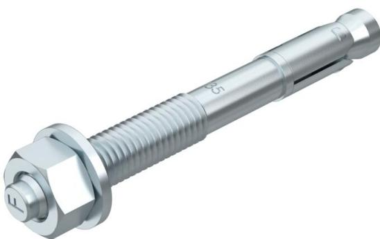
Perno de ancoragem BZ para ancoragem de médias e grandes cargas, tanto em betão armado como não armado. O perno de ancoragem une as cargas elevadas permitidas com pequenas distâncias entre margens e eixos. Avaliação técnica europeia ETA-99/0010, incluindo valores característicos sob efeito de incêndio até uma duração de resistência ao fogo R 120.
