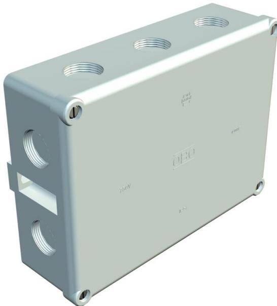
Tipo de protecção IP54, tensão nominal 660 V, secção transversal nominal 16 - mm<sup>2</sup>, 2 aberturas de fixação para parafusos de até 6 mm Ø na parte exterior da caixa. 4 parafusos na tampa, 10 entradas destacáveis com rosca M25 x 1,5..
