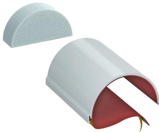
Meia concha com revestimento interior, a qual pode ser totalmente ocupada com cabos e tubos de instalação elétrica. Aplicação em áreas interiores. Produto de construção com marcação CE, com certificação europeia conforme a ETA-13/0904 e homologação técnica geral alemã. Resistência ao fogo até 120 minutos.
