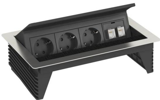
Deskbox oscilante com cabo de ligação para a instalação fixa em mesa, caixa em aço inoxidável polido com saída de cabos de escova. Instalação através de uma abertura de montagem no tampo da mesa de 245 x 157 mm.
