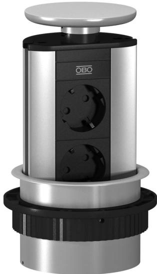
Deskbox retrátil com cabo de ligação para a instalação fixa em mesa, fixação em plástico, pintada conforme a versão. Instalação através de uma abertura de montagem no tampo da mesa (Ø102 mm).
