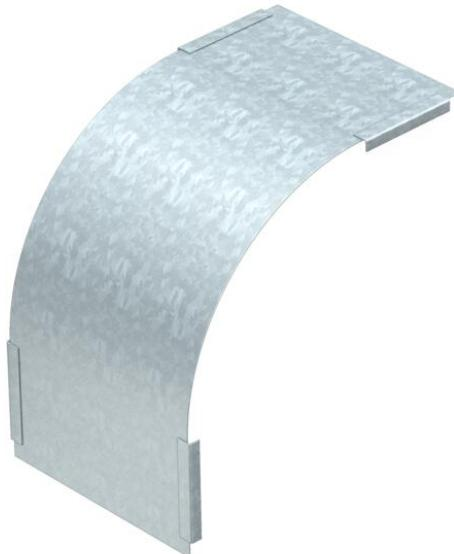
Tampa para ângulos verticais descendentes com altura lateral 60mm. A fixação é garantida pela sobreposição das tampas dos caminhos de cabos em chapa. Adicionalmente, a tampa pode ser fixa com grampos para fixação de tampas.
