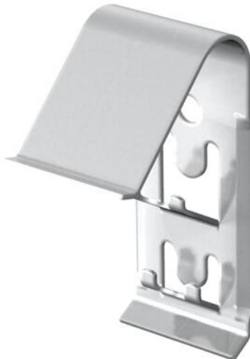
Grampos universais para fixação de tampas não perfuradas em caminhos de cabos em chapa, caminhos de cabos em varão e minicanais AZ. Em função da largura da calha, são utilizados 4 ou 6 grampos para tampas, garantido assim uma fixação segura de uma tampa de 3 m. O grampo para tampas não é adequado para a utilização em caminhos de cabos em varão com uma altura lateral de 35 mm.
