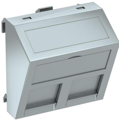
Espelho inclinado Modul 45 para 2 conectores de dados RJ 45. A saída tem uma tampa deslizante de bloqueio, adequada tanto para a instalação vertical como horizontal. O Tipo A tem uma abertura de montagem de 20,10 x 14,80 mm e foi concebido para a fixação directa de conectores de dados.
