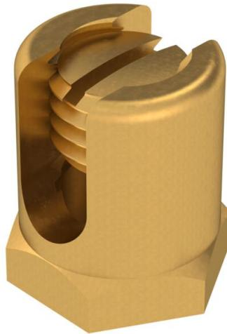
Ligador de terra para fixação do condutor de ligação equipotencial ao sistema de caminho de cabos. Parafuso M12 com ranhura. Adequado para seções transversais de condutores de 4 - 50 mm<sup>2</sup>.
