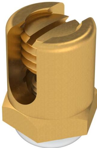
Ligador de terra para fixação do condutor de ligação equipotencial ao sistema de caminho de cabos. Parafuso M12 com ranhura. Adequado para seções transversais de condutores de 4 - 50 mm<sup>2</sup>. Com arruela de pressão e parafuso.
