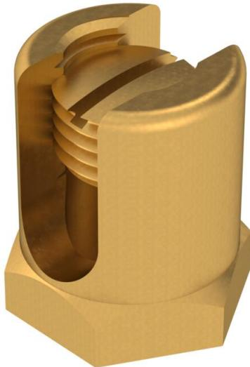
Ligador de terra para fixação do condutor de ligação equipotencial ao sistema de caminho de cabos. Parafuso M14 com ranhura. Adequado para seções transversais de condutores de 25 - 75 mm<sup>2</sup>.
