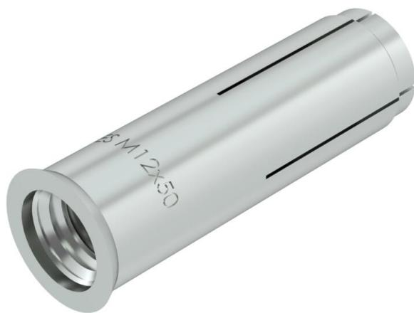
Âncora de fixação para fixação individual de sistemas não portantes em betão não armado e para fixação múltipla em betão armado e não armado.
